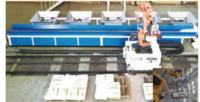
机器人组份破包机 Robot breaking and feeding system
